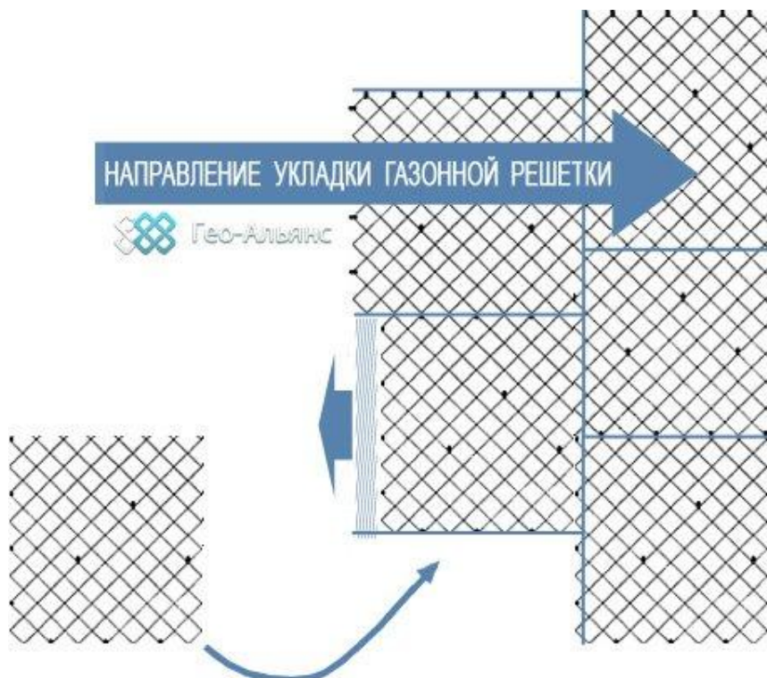
Рис. 1. Схема укладки пластиковых газонных решёток
